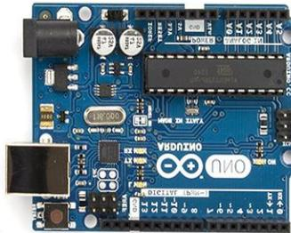
**Fig.4. Arduino UNO****B. TECHNICAL SPECS**
